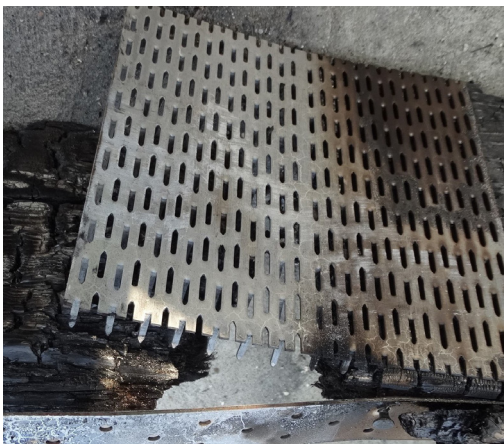
Przepalony pas dolny po 37 minutach
